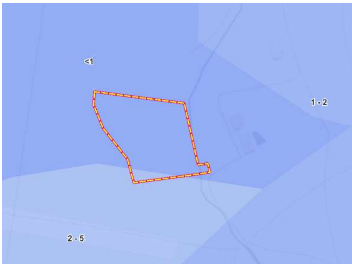
Ryc. Poziom zalegania zwierciadła wód gruntowych w m p.p.t
