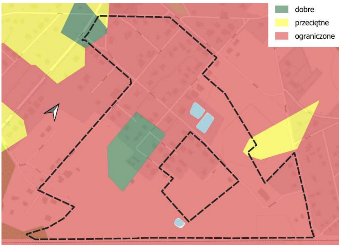
Ryc. Przydatność gruntów do zabudowy na głębokości 2 m pgt wg danych Atlasu geologiczno – Inżynierskiego aglomeracji.
